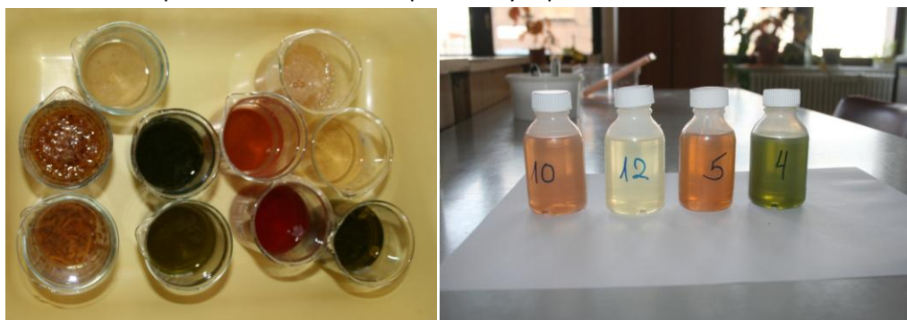
Obr. 17 – vzorky (sušený materiál zalitý metanolem), obr. 18 – vzorky po filtraci
