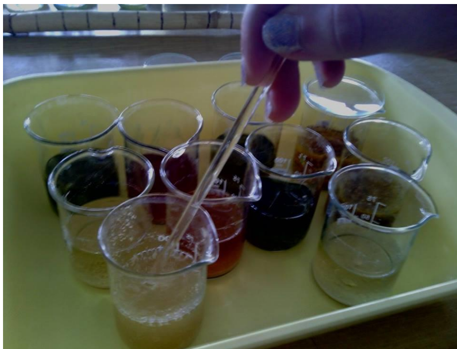
Obr. 22 - příprava vzorků na filtraci, KAŠŠÁK, 2013
