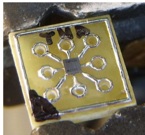
Obr. 2: Obvod TMP006 po naletování
