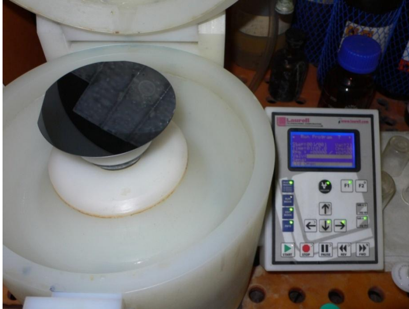
Obr 5.10 - umístění substrátu v odstředivce (spin coateru)
