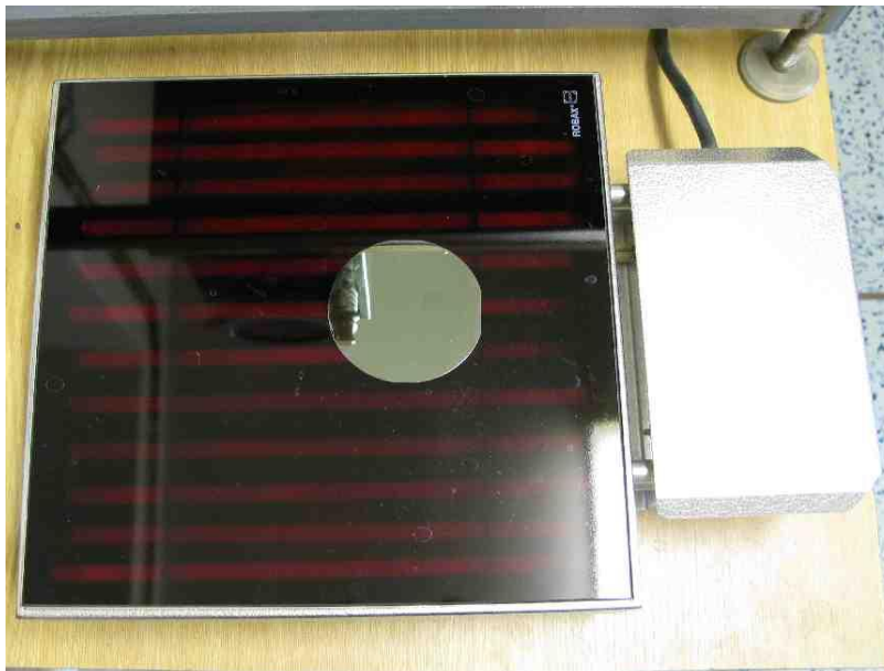
Obr 5.11 - sušení substrátu s naneseným rezistem na „hot plate“
