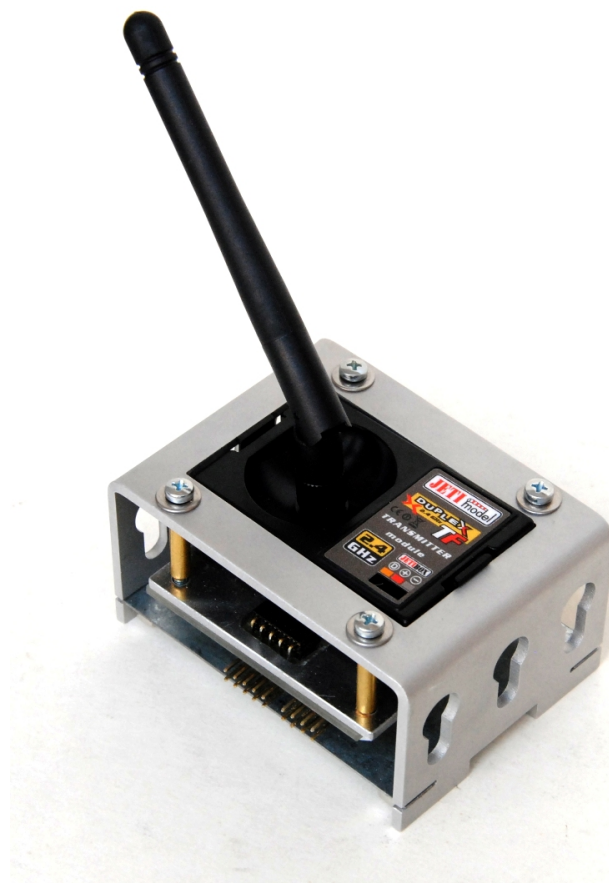
Obrázek 27: 2,4GHz modelářský vysílací modul
