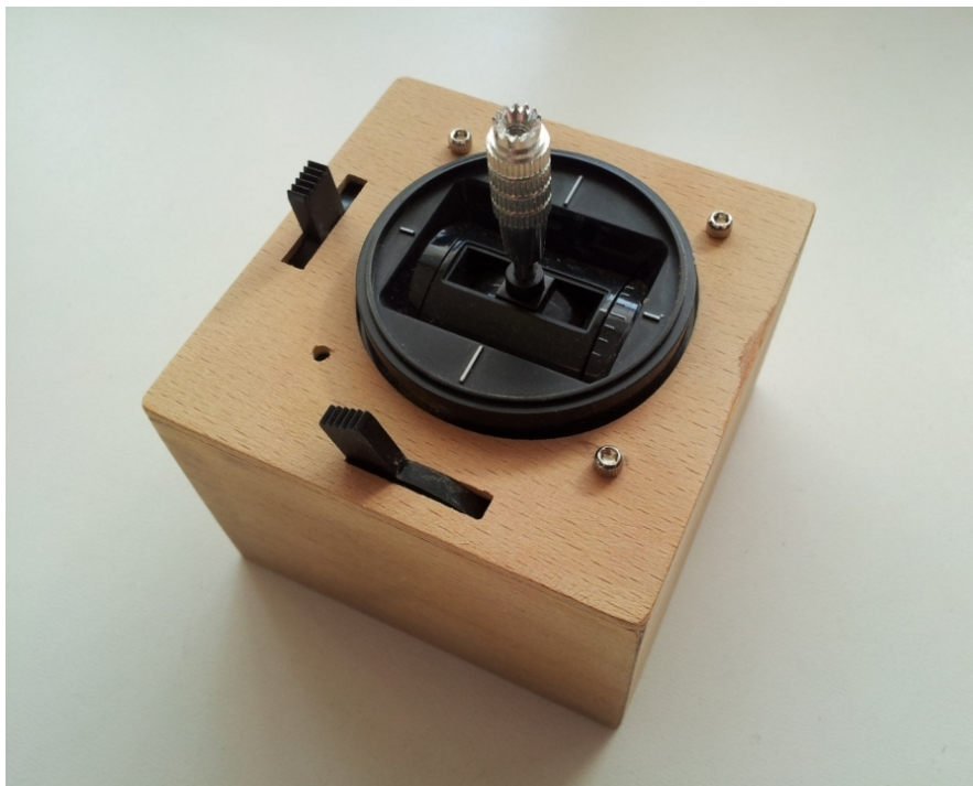
Obrázek 10: Křížový ovladač v překližkovém pouzdře
