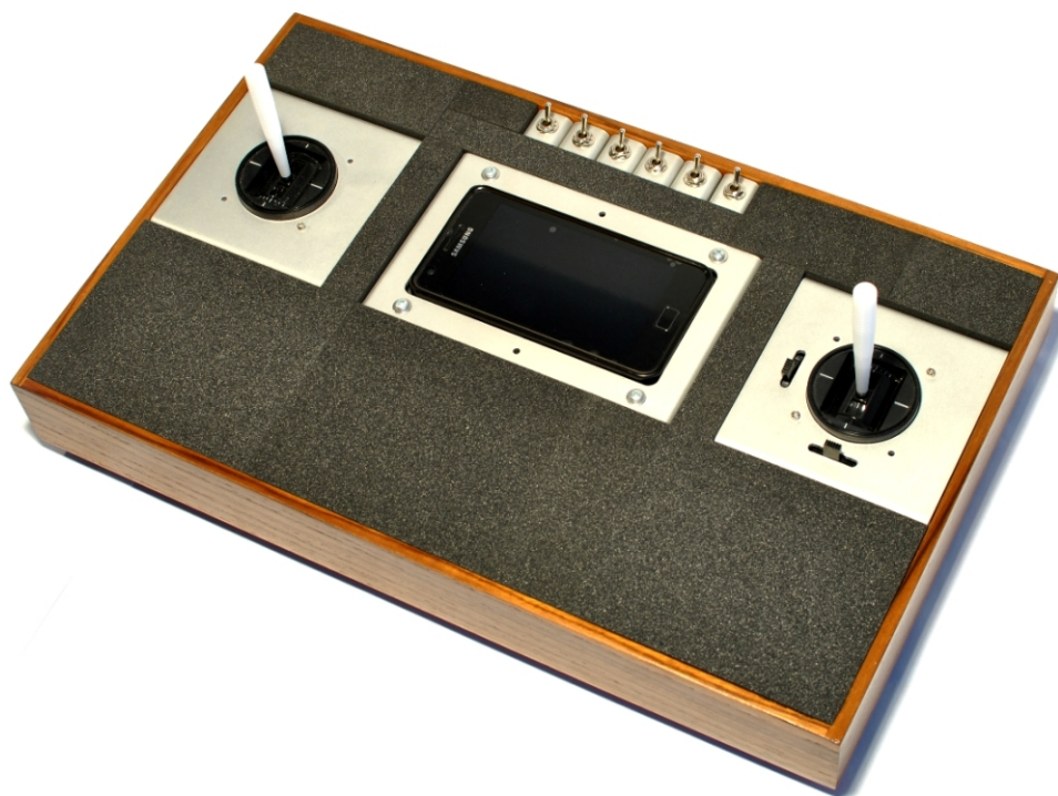
Obrázek 1: Hotová podoba ovladače – jedna z možností uspořádání
