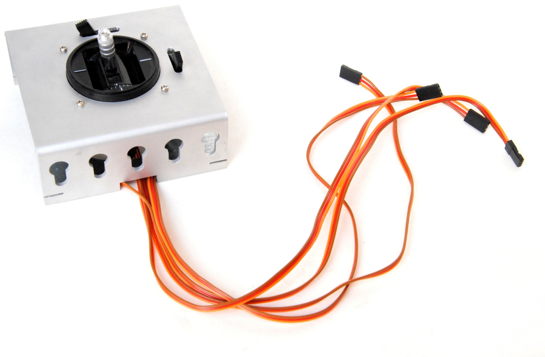
Obrázek 43: Modul s křížovým ovladačem
