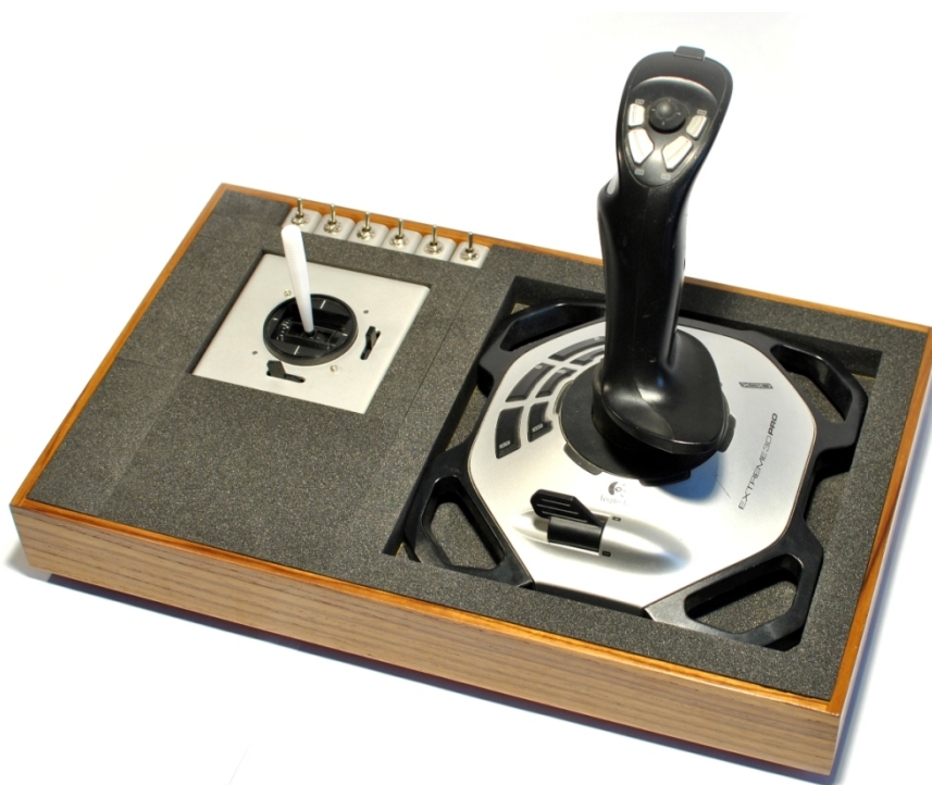
Obrázek 31: Uspořádání pultu s joystickem
