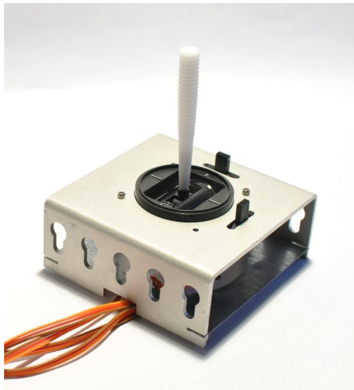
Obrázek 18: Modul obsahující novou páku na křížovém ovladači
