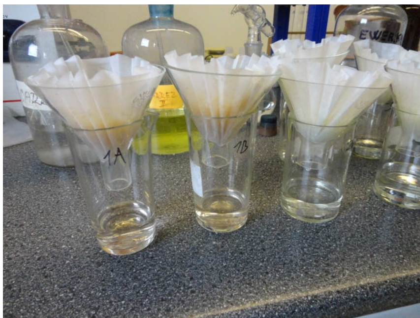
Obrázek 37: Metoda určení škrobu polarimetricky - filtrace
