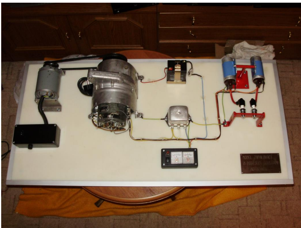
Obrázek 40 - Napojení elektroinstalace a namontování rohových lišt
