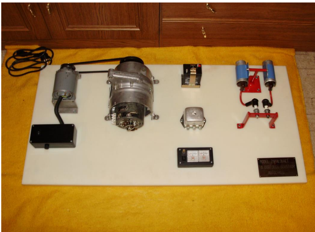
Obrázek 38 - Rozmístění a namontování dílů na základovou desku
