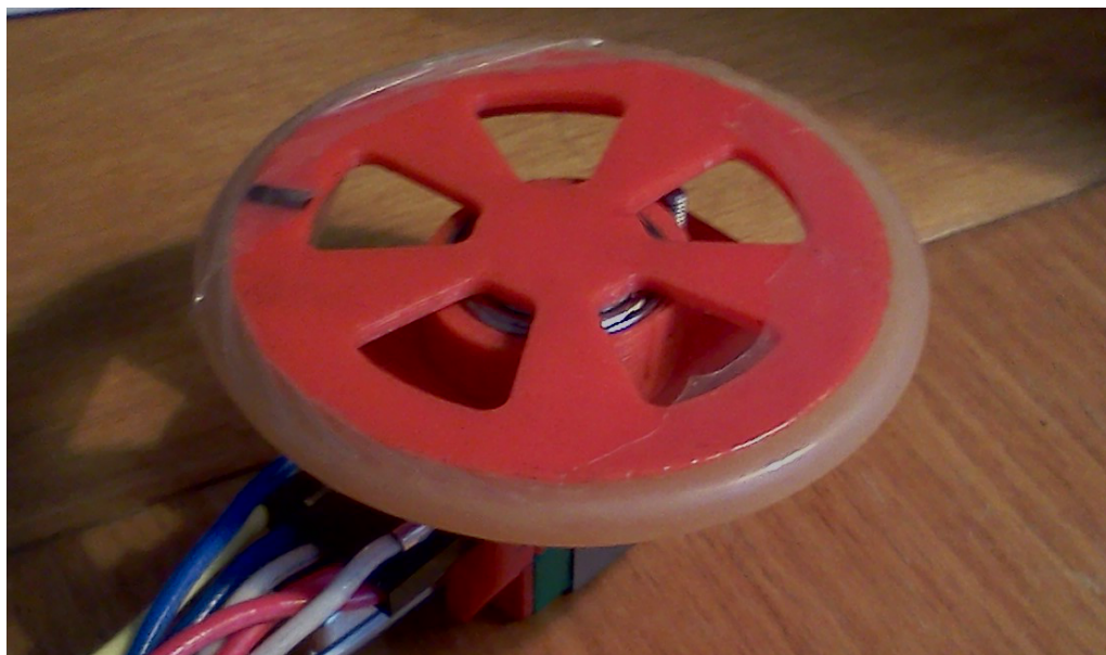
Obrázek 30: Magnetický enkodér
