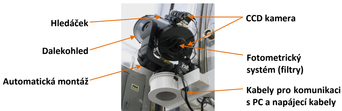
Obr. 4: Fotografie instrumentálního vybavení pro CCD fotometrii s popisky jednotlivých komponentů, fotografie převzata z [10]
