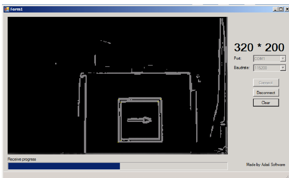
ob 2.1.1 – výstup cannyho hranového detektoru
