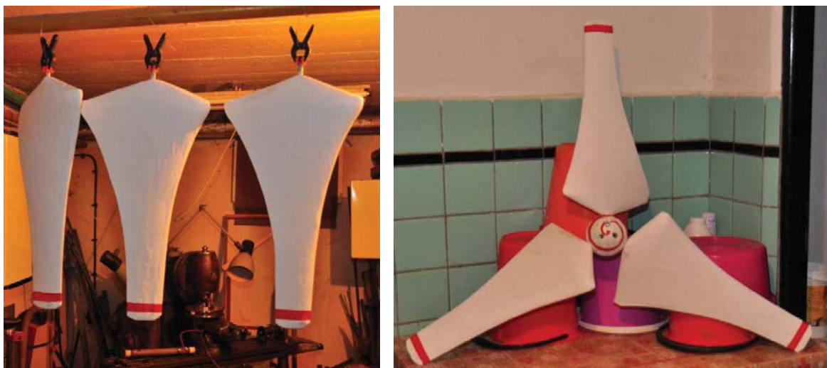
Obrázek 9.1: Sušení nově natřených listů při první údržbě v lednu 2012 (vlevo) a pohled na složený rotor (vpravo)
