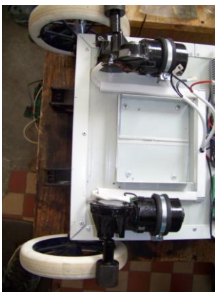
(Obr. 9 a 10, rozložení částí robota na vrchní straně PUR panelu)
