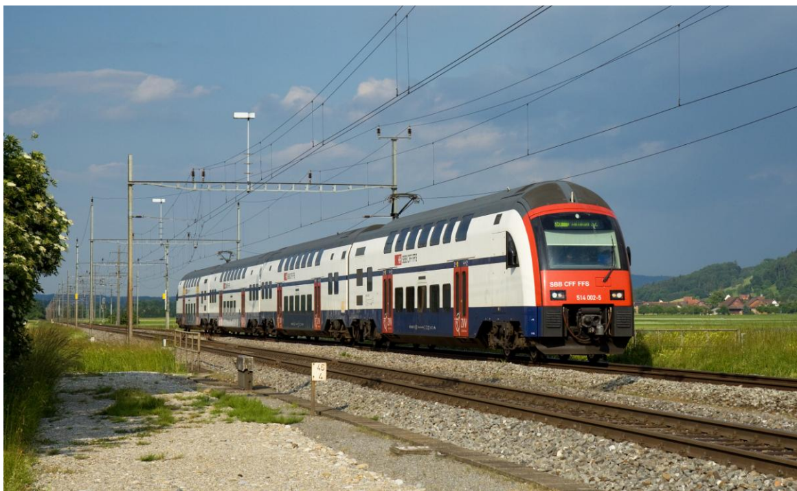
Obrázek 15: Patrová jednotka RABe 514 SBB (celá jednotka) – výrobce Siemens KV Praha-Zličín
