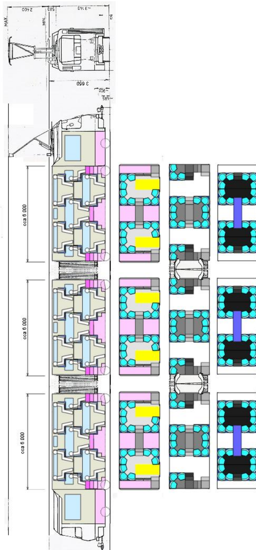
Obrázek 41: Tramvaj 3-180-24 složená z unifikovaných modulů
