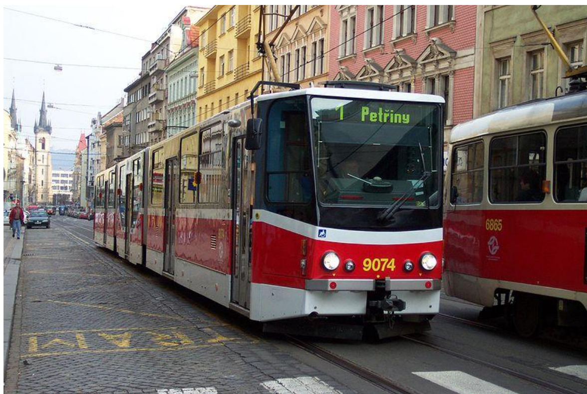
Obrázek 42: Modernizovaná tramvaj KT8D5RN s vloženým nízkopodlažním dílem
