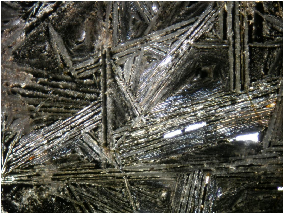
Obr. 41: Mikrofotografie výbrusu č. I, (fayalit, sklo). Výbrus, nikoly X. Spodní strana záběru 0,48 mm.
