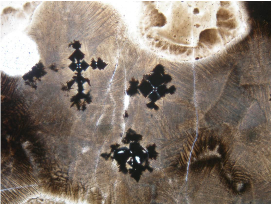
Obr. 45: Mikrofotografie výbrusu č. IV (fayalit, wüstit, sklo). Výbrus, 1 nikol. Spodní strana záběru 0,48 mm.
