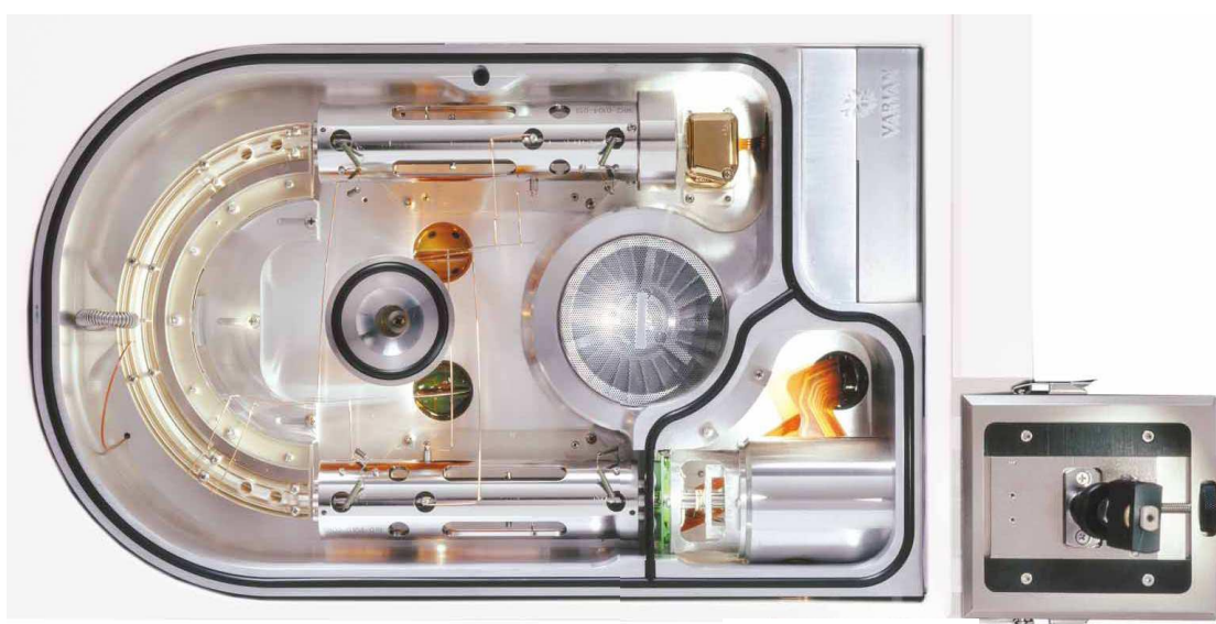
Obrázek 20: MS spektrometr Varian 1200L
