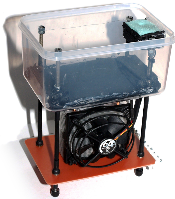
Obrázek 5.22: Otevřená postavená mlžná komora – čelní pohled. Uvnitř je vidět vytápění a zásobník isopropanolu.
