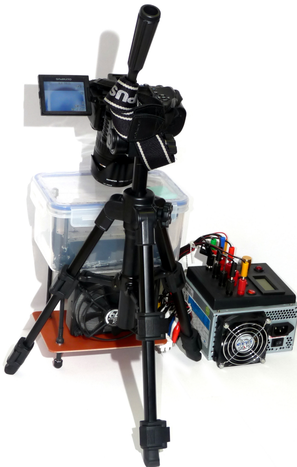
Obrázek 5.25: Při pořizování fotografií stop částic v komoře byl fotoaparát umístěn nad komoru pomocí stativu.
