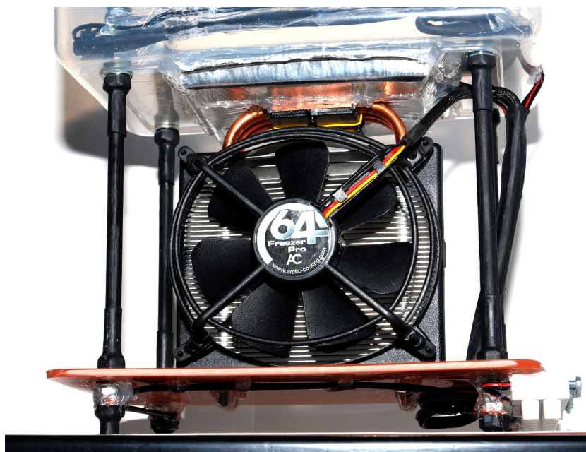
Obrázek 5.10: Konečná verze chlazení postavené mlžné komory obsahuje hliníkovou fólii pro rozvod tepla i izolaci.
