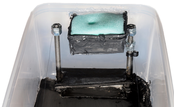
Obrázek 5.18: Na dně komory je mezi závitovými tyčemi připevněno osvětlení se stínítkem. U horní části komory je pak zásobník isopropanolu (zelená houbička). Mezi konci závitových tyčí je natažen odporový drát pro vytápění horní části komory.
