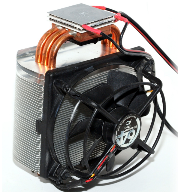
Obrázek 5.2: Dva peltierovy články s teplovodivou pastou nasazené na chladiči procesoru z počítače.
