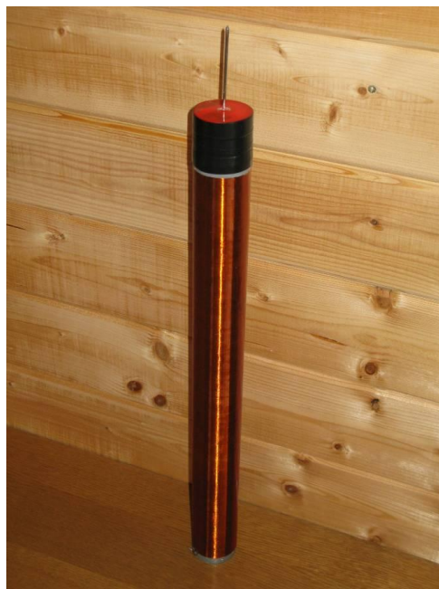
Obr. 12: Navinutá sekundární cívka s hrotem
