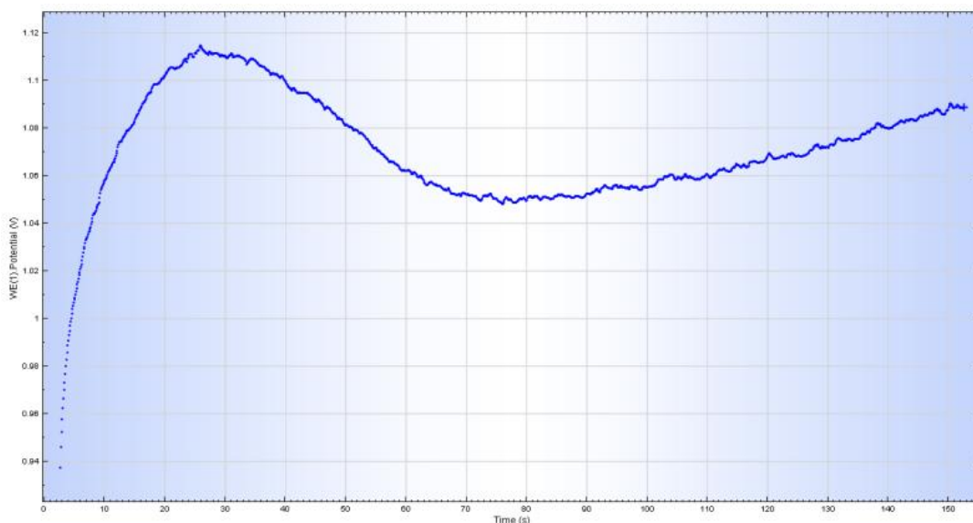
Obrázek 3.3 Obvyklý průběh el. potenciálu – po počátečním nabití částic na rozhraní materiálů dochází k snížení napětí nutného pro průběh reakce, po krátké době však opět dochází k nárůstu, jelikož částice, které byly v dosahu elektrody již zreagovali a na přiblížení vzdálenějších částic je zapotřebí větší napětí.
