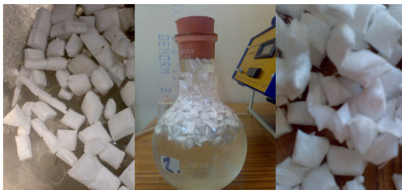
Obr. 17: HR2200 příprava: nastříhání, praní a sorpce snížit OAR na úroveň pod 300 Bq/l.
