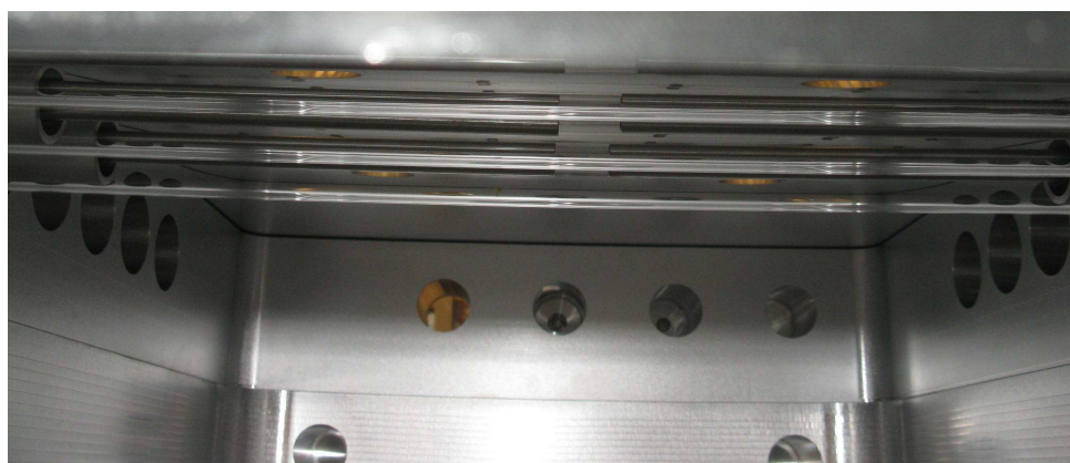
Obr. 2.6.: Zdroje mikrovlnného plazmatu – lineární antény (MW aplikátory)
