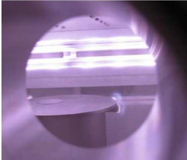
Obr.2.9.: Si substrát na podložce během depozice
