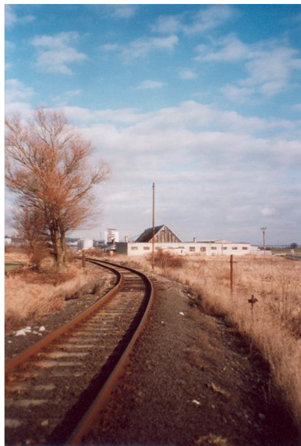
Obrázek 30.: Pohled na střížák bývalého vjezdového návěstidla (uprostřed), železná konstrukce vpravo od kolejí sloužila k napínání drátu. V pozadí stojí sklad Agrochemického podniku, 9. 2. 2009. Foto: autor.
