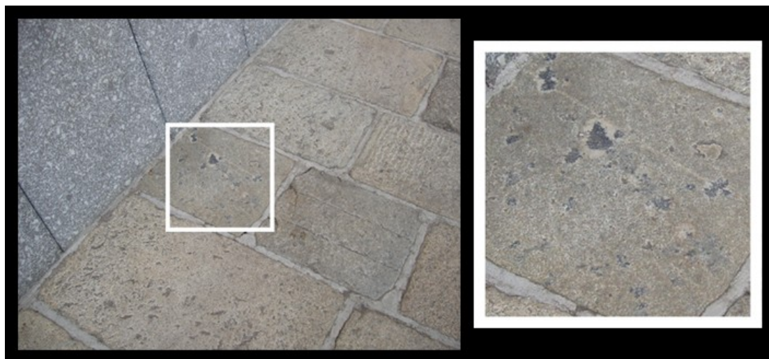
Obr. č. 31: Křemen-turmalínové shluky na dlažbě pocházející z žilných žul těžných v lomech na v. svahu Malého Mehelníku (lokalita: Písek - parkoviště u Děkanského kostela Narození Panny Marie v Písku; foto: březen 2010).
