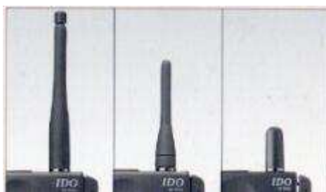
3.3 Průběh minaturizace antény [4]
