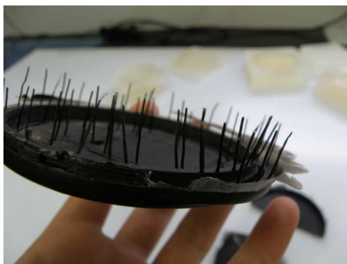
8.5 Detail odlitých odvzdušňovacích kanálků před jejich odstraněním
