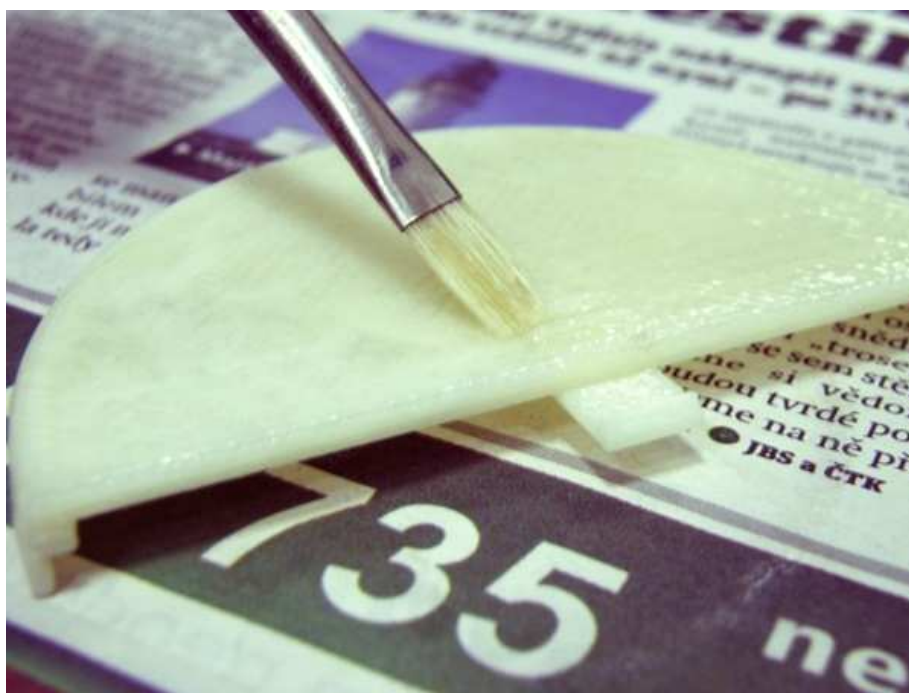
7.4 Natírání vytisknuté části modelu acetonem
