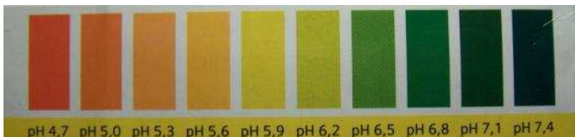
Obrázek 8: Stupnice pro stanovení pH vody
