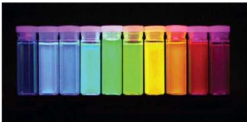
Obr. 9 - Kvantové tečky různých velikostí emitují při ozáření UV paprsky světlo o různé vlnové délce
