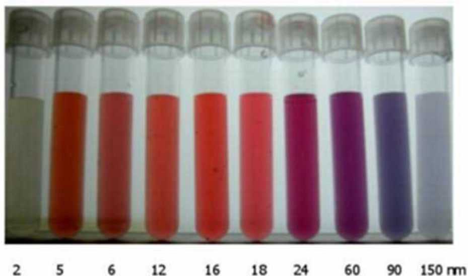
Obr. 10 – Barva koloidního roztoku zlata v závislosti na velikosti Au částic
