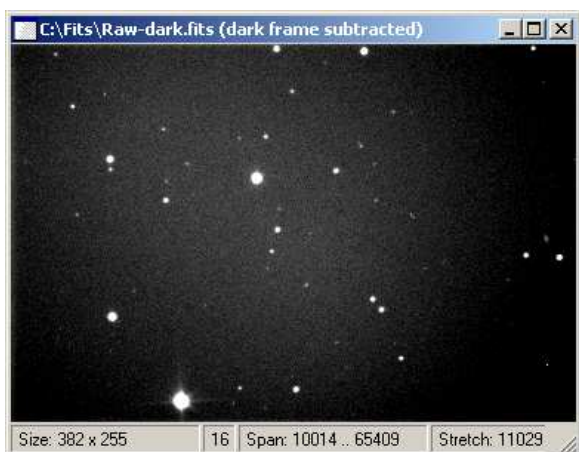
obr. 6 raw snímek po odečtení dark frame
