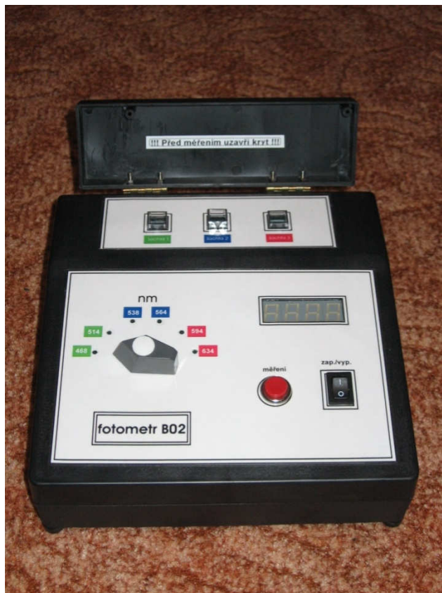
Obr. 13 Kompletní fotometr B02, pohled 2
